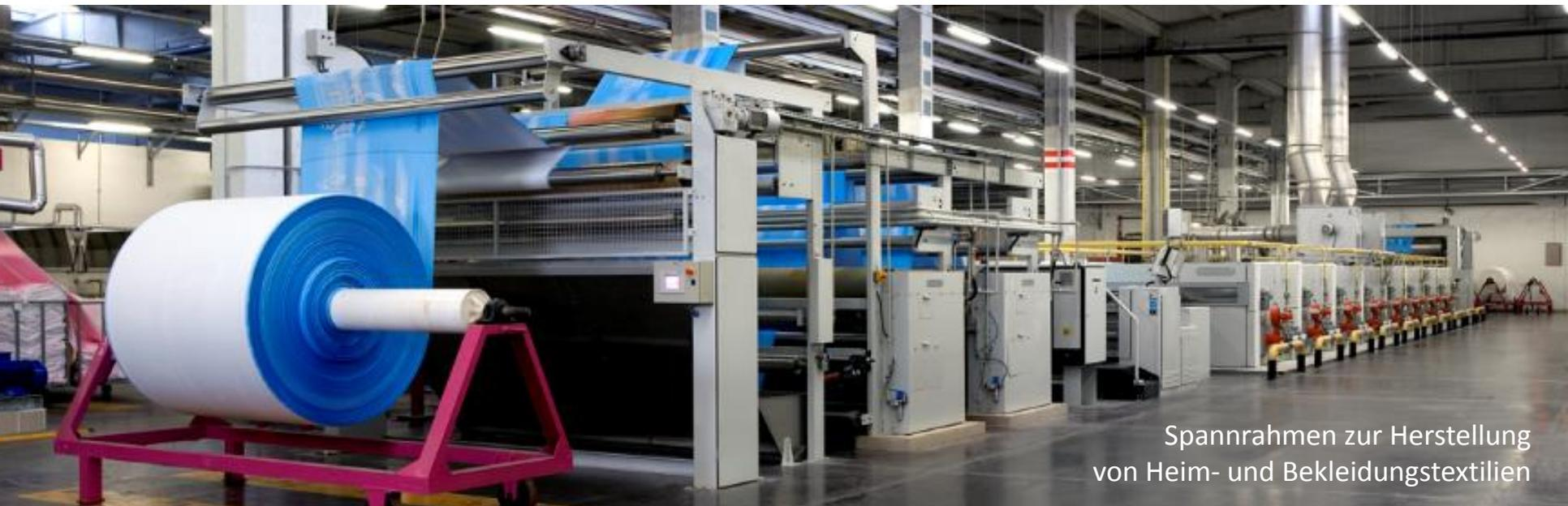
Spannrahmen zur Herstellung
