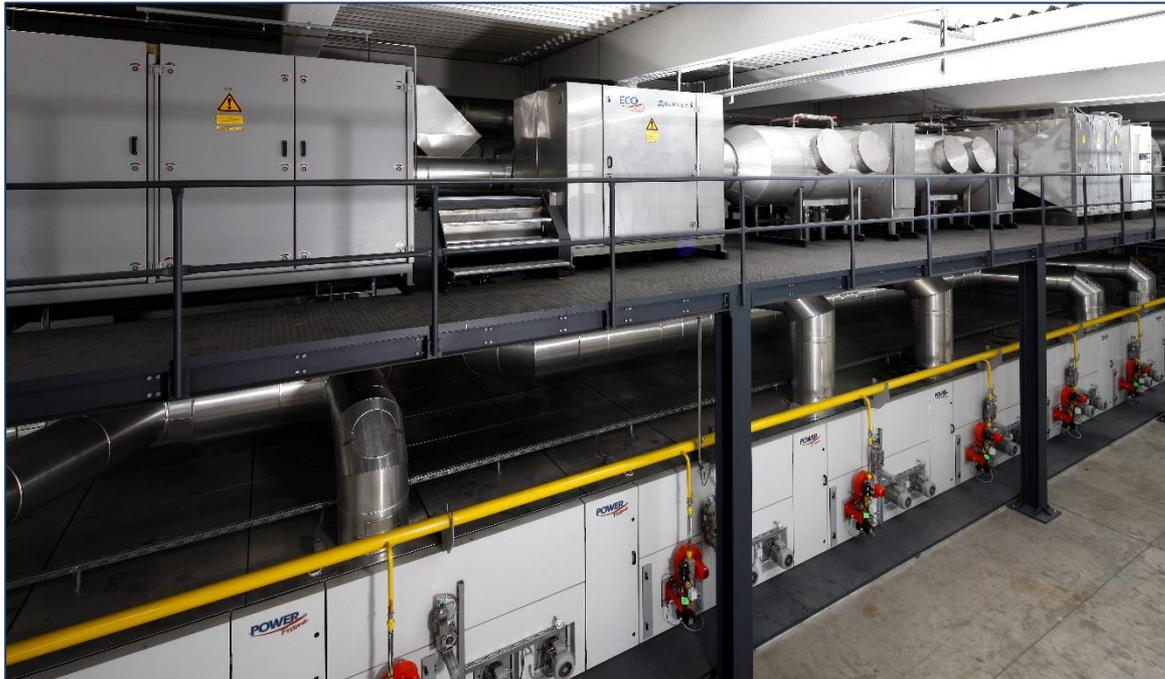
Textil-Spannmaschine mit vollstufiger Wärmerückgewinnungs- und Abluftreinigungsanlage
